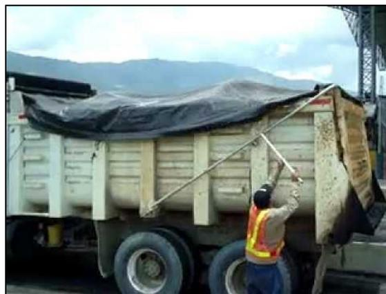
Figura 13 Ejemplo de camión transportador cubierto
